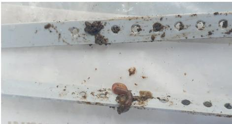
Abbildung 6. Bait Lamina Streifen direkt nach Entnahme aus dem Boden. Foto A. Batson
